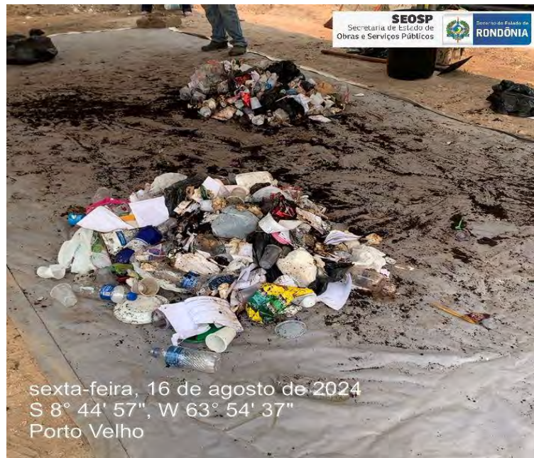
Figura 4 – Exemplo seleção de duas partes do quarteamento primário. Fonte: Acervo, 2024.
