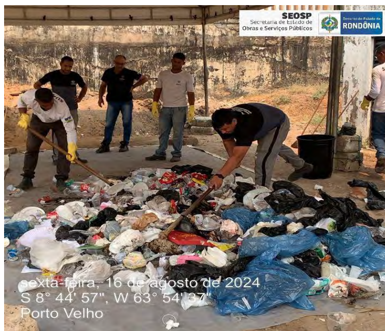
Figura 2 – Exemplo de homogeneização de amostra de resíduos sólidos. Fonte: Acervo, 2024.
