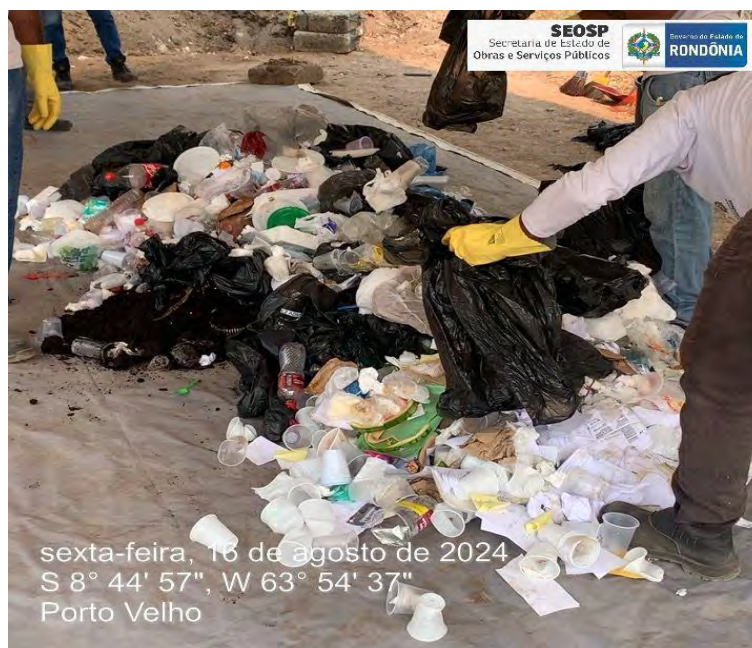
Figura 1 – Exemplo de descarregamento de resíduos em lona para amostragem. Fonte: Acervo, 2024.
